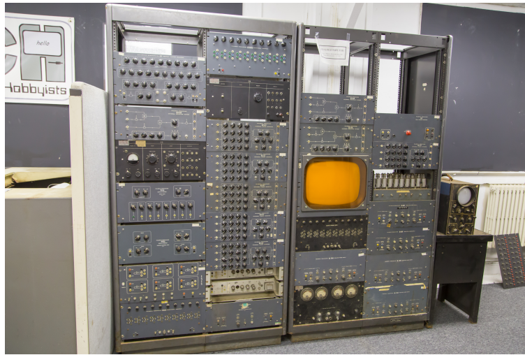
Figure 64: Philbrick analog computer at MIT ( www.analogmuseum.org ).
